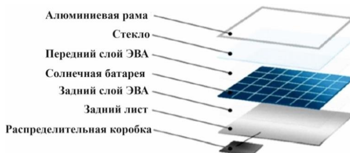
Рис. 2. Типичная сборочная конструкция фотоэлектрического модуля [5]
