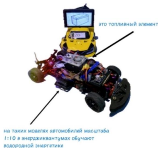
Рис. 3. Топливный элемент и модель автомобиля масштаба 1:10
