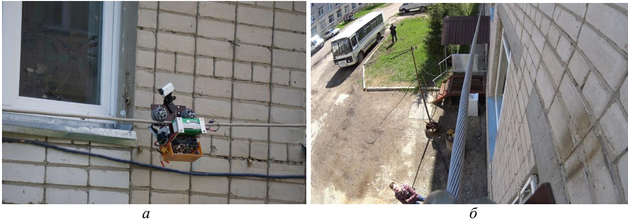
Рис. 1. Прототип роботизированного комплекса, разработанного в КГЭУ: а – внешний вид прототипа, б – фото с камеры прототипа
