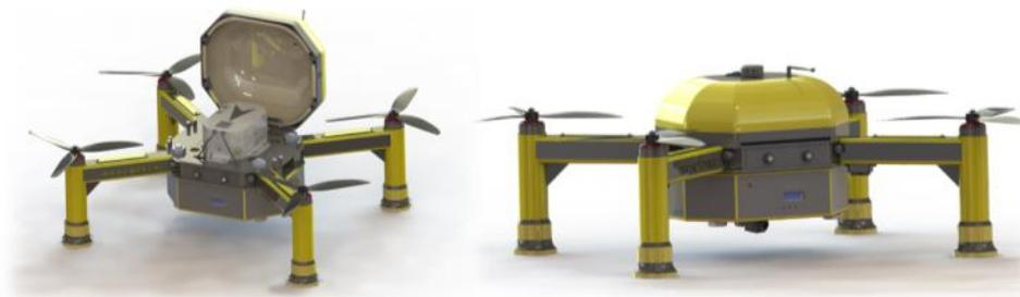
Рис. 1. Беспилотный летательный аппарат для мониторинга возгораний
