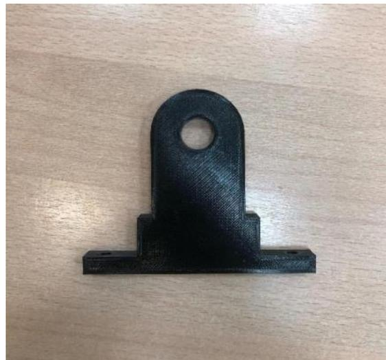
Рис. 3. Фиксатор вала
