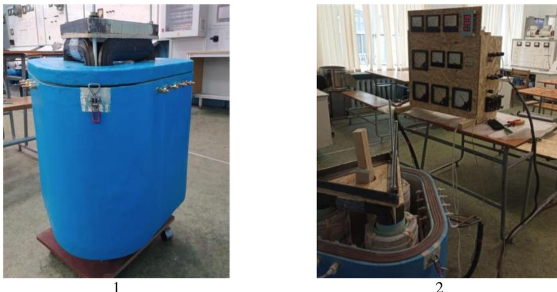
Рис. 2. Испытания СГТ: а – рабочая модель СГТ в сборе; б – СГТ подключен к испытательному стенду
