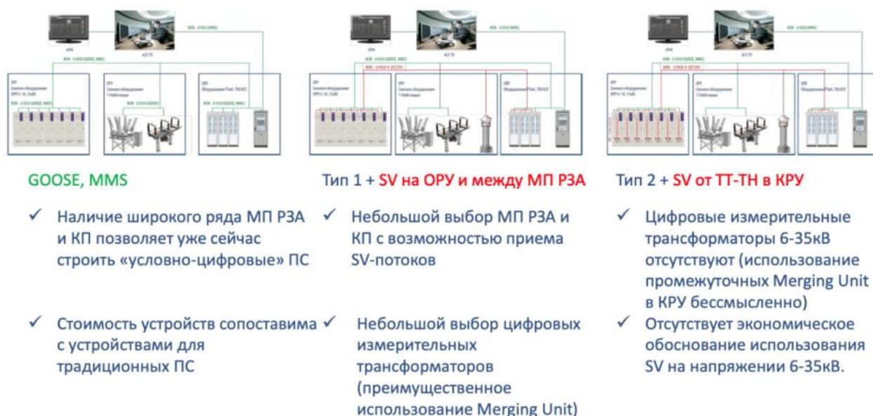
Рис. 1. Сравнение архитектур цифровых подстанций
