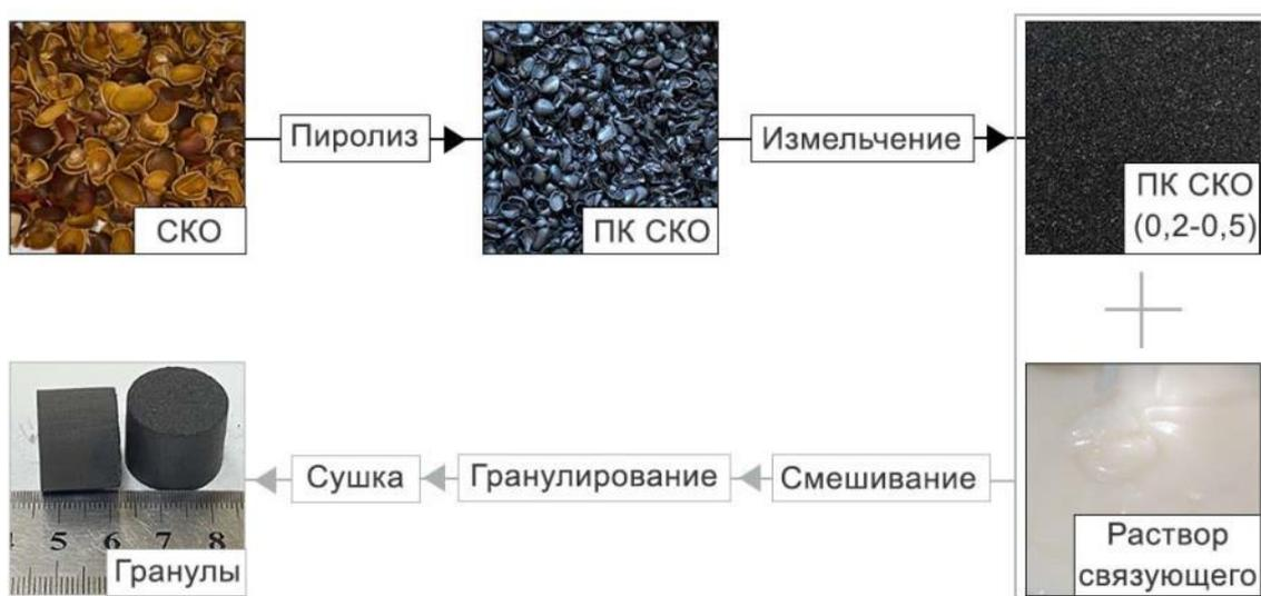
Рис. 1. Схема получения биоугольных гранул
