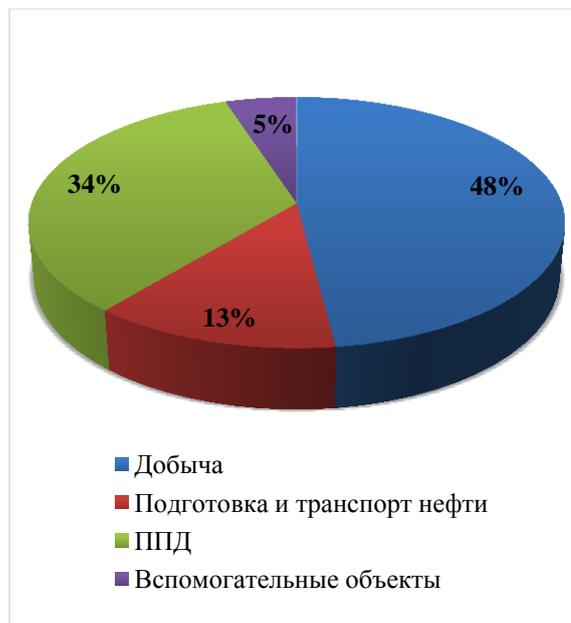
Рис. 1. Диаграмма распределения электрических нагрузок нефтегазового месторождения по технологии
