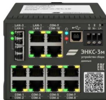
Рис. 2. Устройство сбора данных
